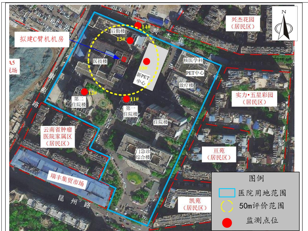
图 8-2 拟建 C 臂 CT 机房周围 50m 评价范围内本底监测点位示意图
